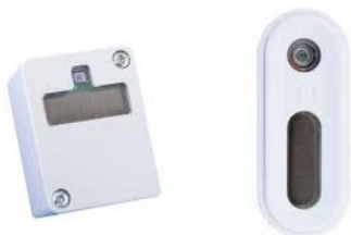
Joonis 5: EnOcean välisvalgustuse EEP A5-06-01 (vasakul) ja sisevalgustuse EEP A5-06-02 (paremal) andurid [13,14]
