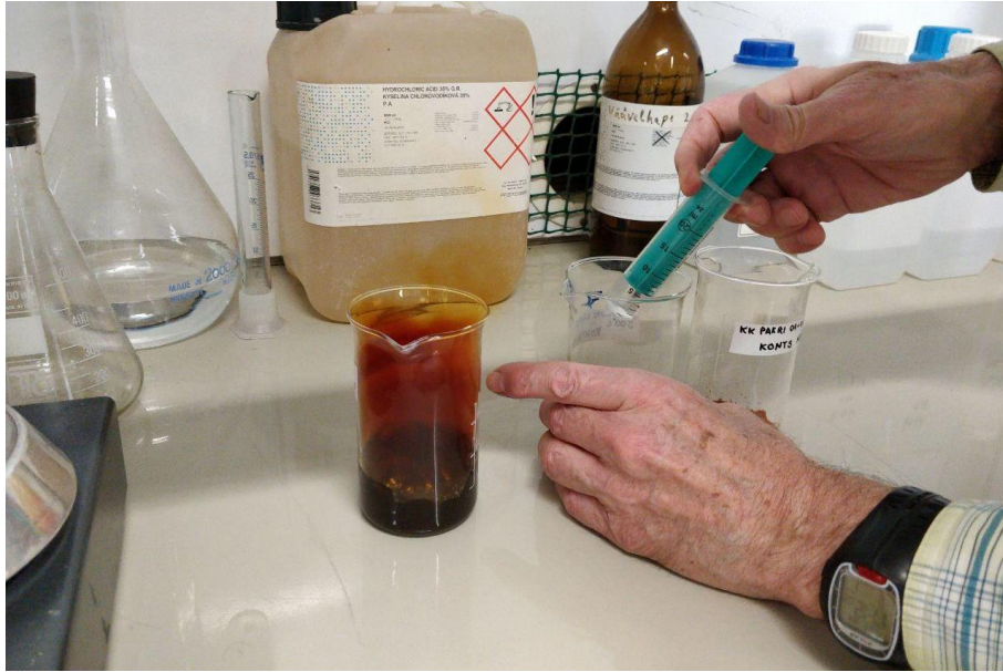
Joonis 4. Kontsentreeritud happe lisamine (paremal) ja reaktsioon graptoliitargilliidiga (vasakul).
