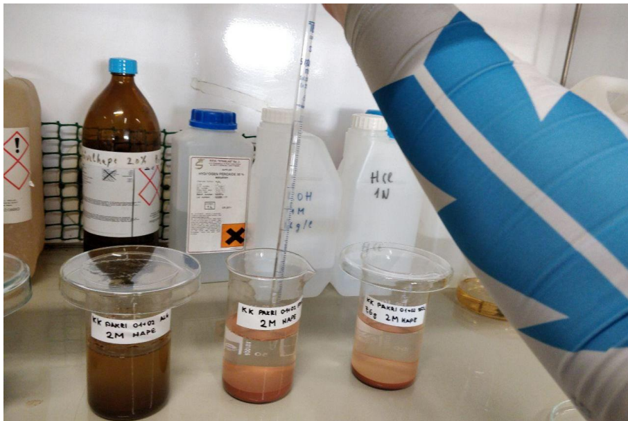
Joonis 5. Proovi võtmine lahusest ICP-MS analüüsi jaoks.
