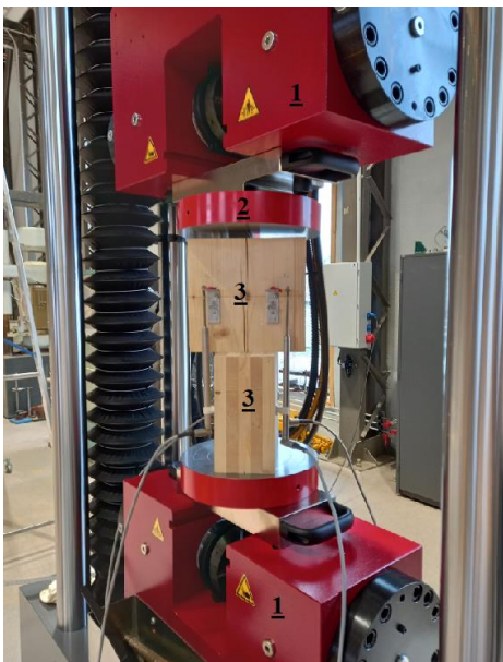
Joonis 4.6 Katsemasin katseseeria SK läbiviimiseks: 1- katsemasina raam; 2- liigendiga jõurakendusplaat; 3- katsekehad
