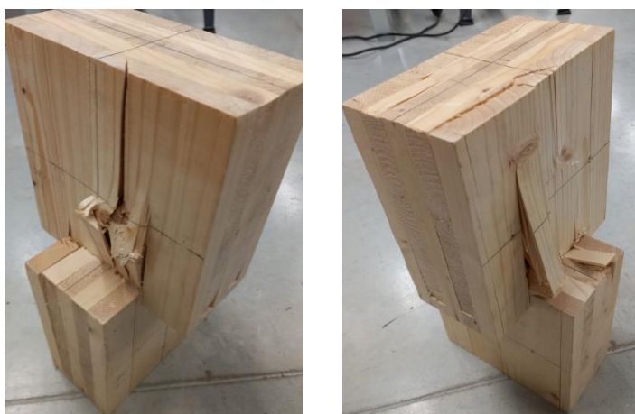
Joonis 5.24 Liidete purunemispildid survekatsetel SK-1 (vasakul) ja SK-2 (paremal)
