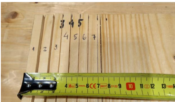
Joonis 5.14 Vertikaalsed lõiked kontrollimaks ristlamellide vigastuste ulatust katsekeha suunas
