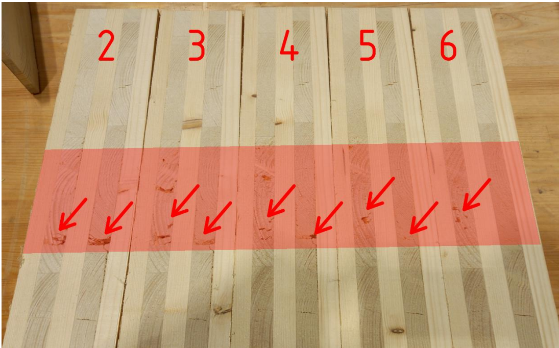
Joonis 5.15 Numbriliselt tähistatud väljalõike osade järjekord. Punasega tähistatud ligikaudne tapihamba mõjuala. Nooltega osutatud vigastatud ristilamelli piirkondadele
