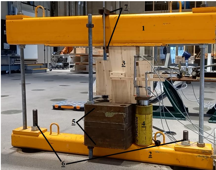
Joonis 4.5 Katseseadeldis NK: 1-ülemine jäik raamiosa; 2- alumine jäik raamiosa; 3- katsekeha; 4- õlitungraud; 5- terasplaadid rihtimiseks; 6- kinnitused läbi jõupõranda, 7- lisakinnitid
