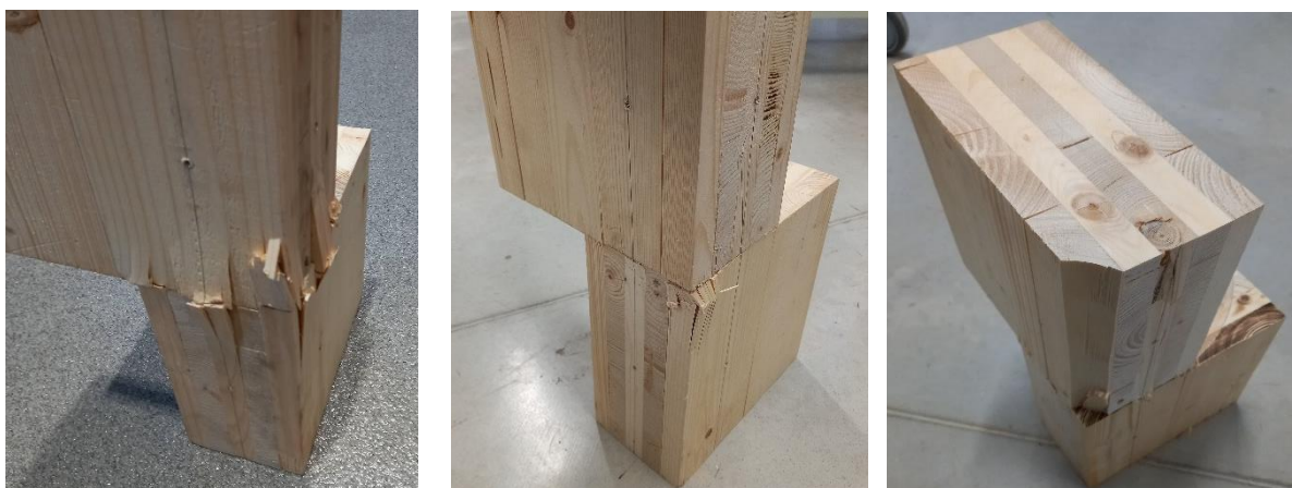
Joonis 5.23 Purunemispilt katsetel alustades vasakult: SK-3, SK-4 ja SK-5
