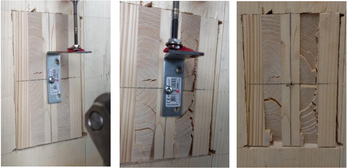
Joonis 5.31 TK-1 katse tapiotsa ristilamellide pragunemine. Paremäl pragunemine ca 10 mm siirdel, keskel ca 35mm siirdel, paremal 43mm siirdel
