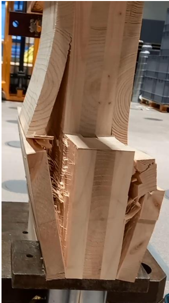
Joonis 5.13 Ühelt küljelt armeerimata lamellide purunemine
