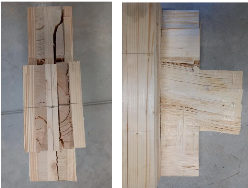
Joonis 5.32 TK-1 tapigakatsekeha vigastuste ulatus. Parem poolsel fotol vertikaallõige ristkihist TK-1 katsel koormati katsekeha 42mm siirdeni, mille tõttu ka ristkihis tekkinud vigastused ulatusid kaugemale katsekeha põhiosa sisse kui nihkekatsel. Joonis 5.33 on esitatud katsekehast ristlõiked tapist 90mm ja 150mm kaugusel. Ristkihi vigastused sumbusid antud juhul ca 150mm sügavusel.
