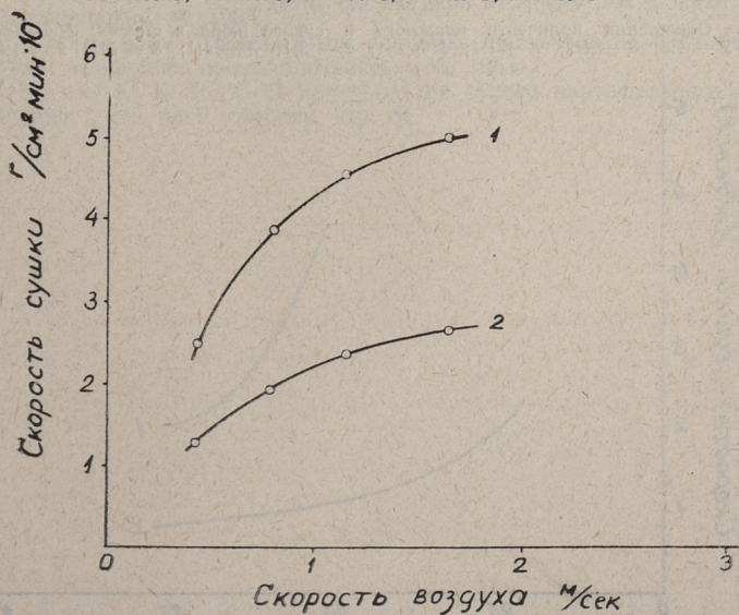
Фиг. 3. Зависимость средней скорости сушки от скорости воздуха в первом (1) и во втором (2) периоде. Температура воздуха 95°C, толщина слоя пюре 1 мм
