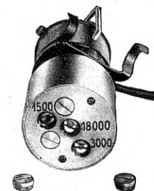
Joon. 5. Põhjas on olemas painsa võlli jaoks 3 ühendusaset.
