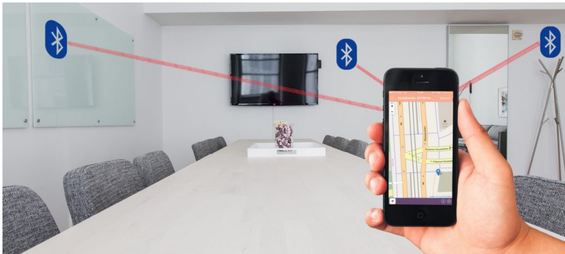
Joonis 2. Majakate asetuse järjestikku kolmnurkseks arvutuseks [7]
