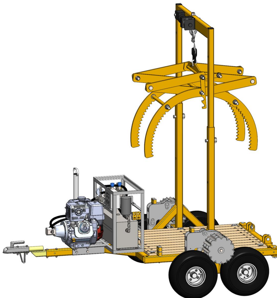
Joonis L4.1. Valmis ehitatavad seadmed (hüdrauliline jõujaam ning rataste ajamid) haagise külge paigutatuna
