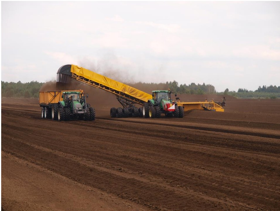
Joonis 2. Freesturba tootmine [3].
