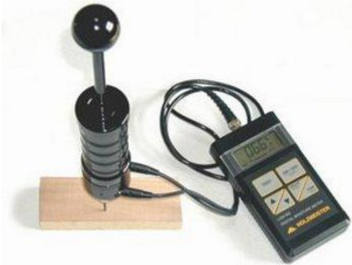
Joonis 14 – Elektritakistuse meetodil niiskussisaldust mõõtev aparaat Logica LG9-NG
