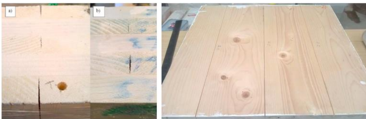
Joonis 6 – Mahumuutustest põhjustatud praod piki lamelle ning lõikeservades [19]
