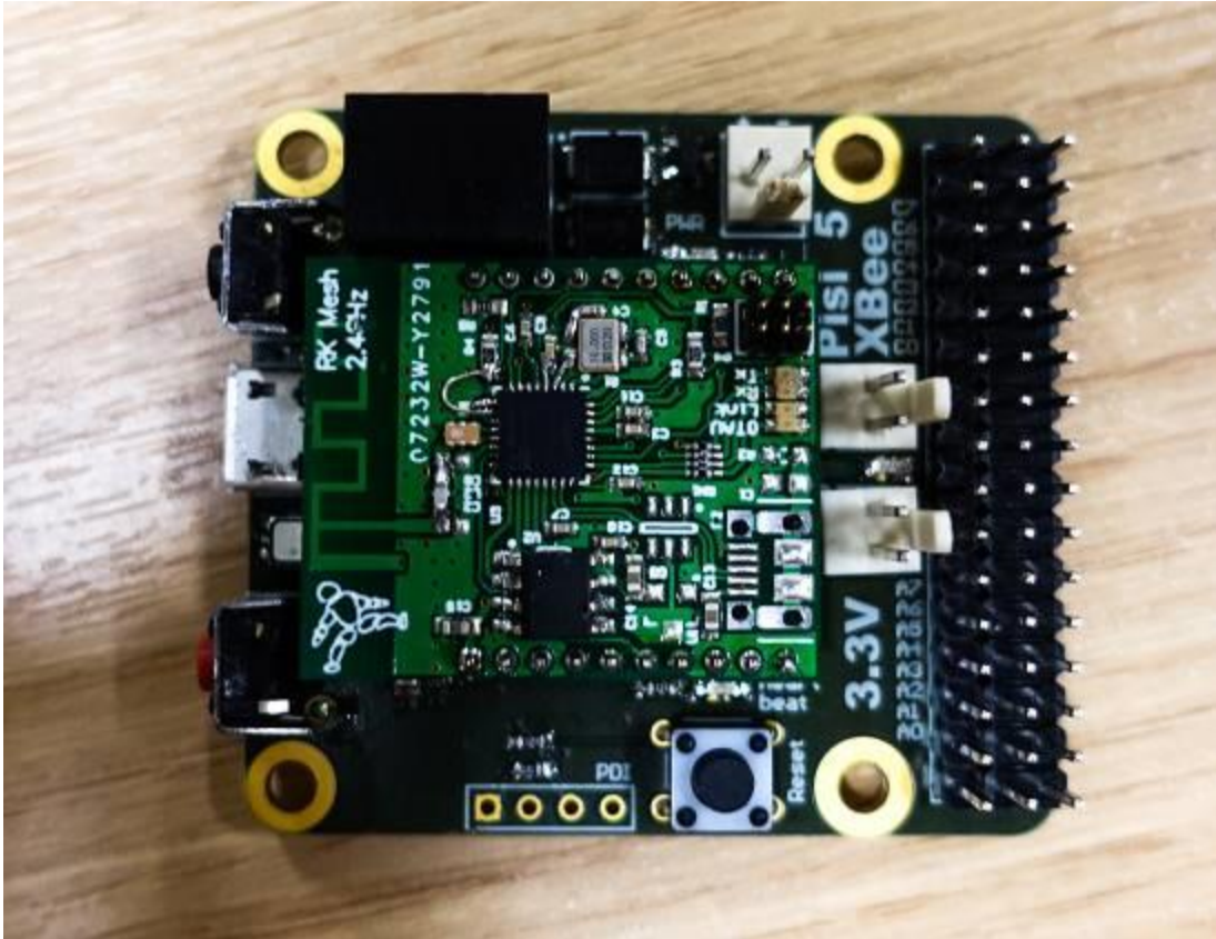
Sele 19 Raadiomoodul PisiXBee 5 alusplatvormil
