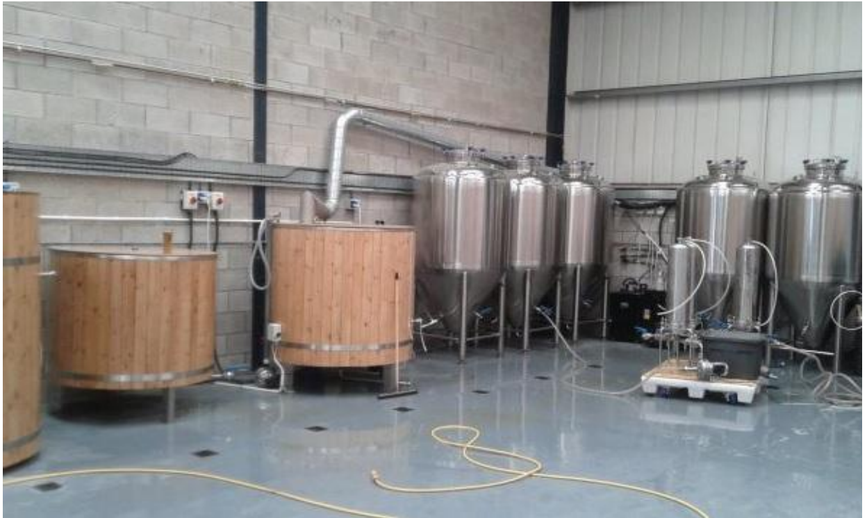
Joonis 1. 1300 liitrise meskimis- ja keedunõuga ning viie kääritustankiga tehas
