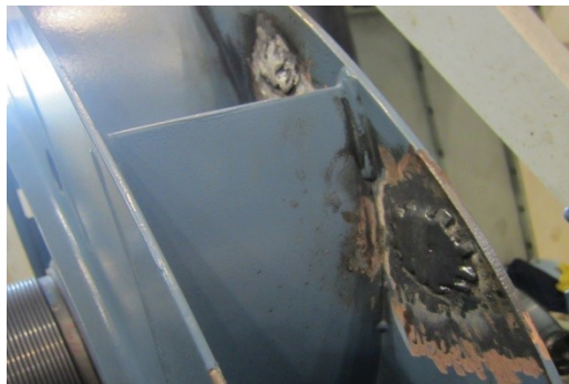
Joonis 3.3 Keevitatud vastukaal ventilaatoril [14]
