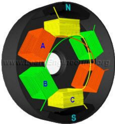
Sele 1.11 Välise rooriga harjadeta alalisvoolumootor [13]
