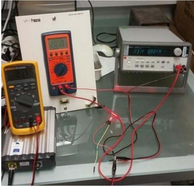
Sele 3.8 Valgusdiodi pingete ja voolutugevuse suhte mõõtmine
