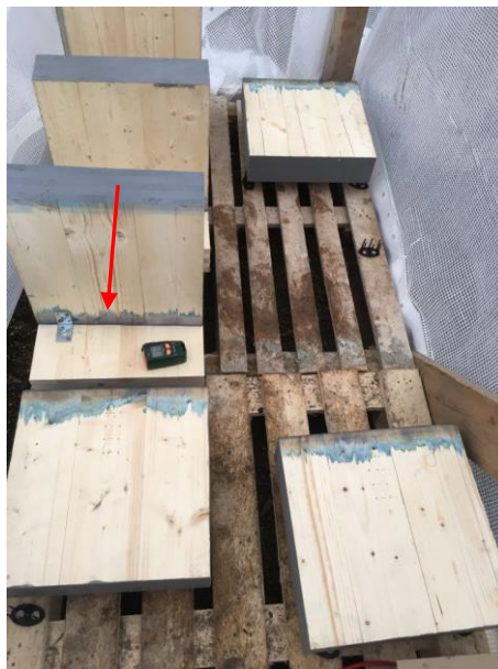
Joonis 1.21. Katsekehade kuivamine väljaskeskkonnas. Katsekehad ei puutunud määratud alusega kokku. Punase noolega näidatud katsekeha paiknemine vastu veeauru difusiooni takistavat pinda
