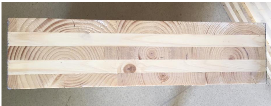
Joonis 1.3. Katsekeha lõikeserv, mis on töödeldud veepõhise alküüdkruntvärviga
