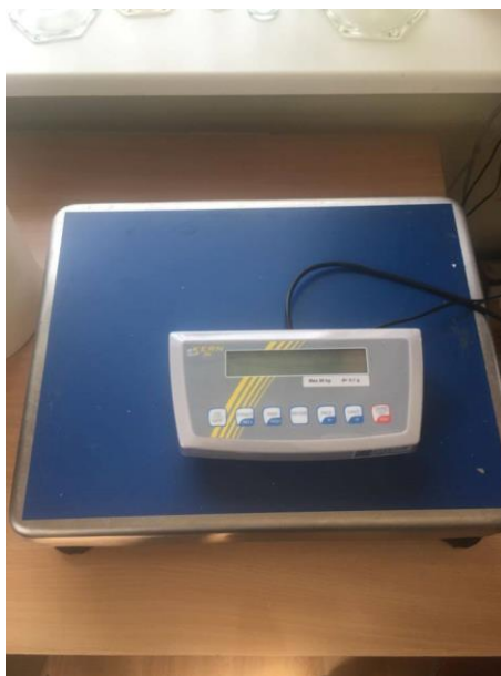
Joonis 1.6. Katsetel kasutatud kaal Kern DS 30K0.1L
