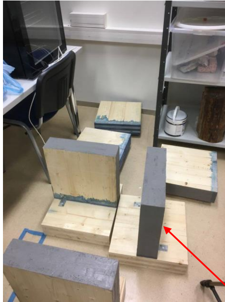
Joonis 1.20. Katsekehade kuivamine laboris. Punase noolega näidatud katsekeha paiknemine vastu veeauru difusiooni takistavat pinda
