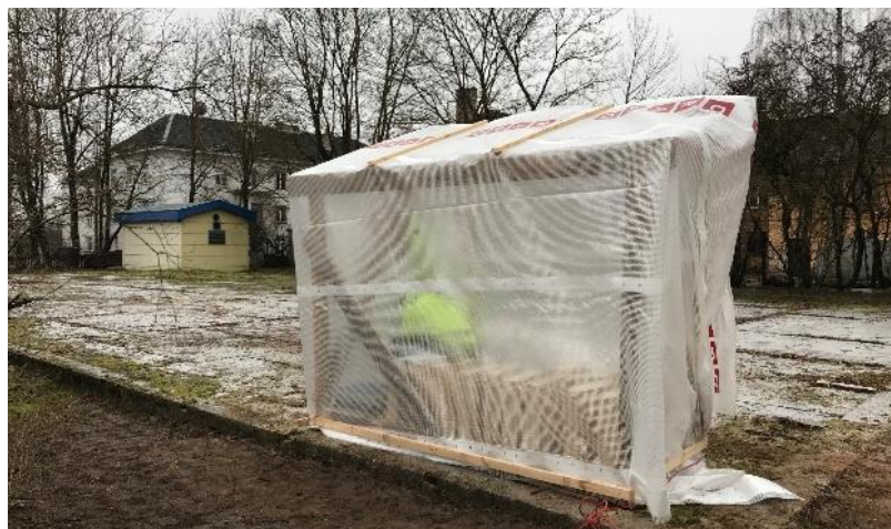
Joonis 1.13. Välja rajatud varjualune konditsioneerimiseks ning kuivatamiseks välitingimustes
