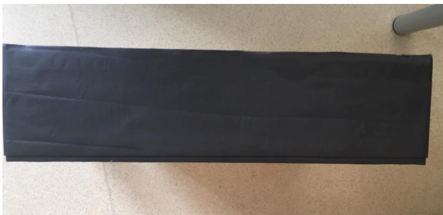
Joonis 1.1. Katsekeha lõikeserv, millele on liimitud hermetiseerimislint
