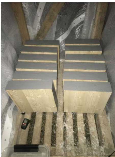
Joonis 1.15. Katsekehade konditsioneerimine pärast vedelkummi peale kandmist
