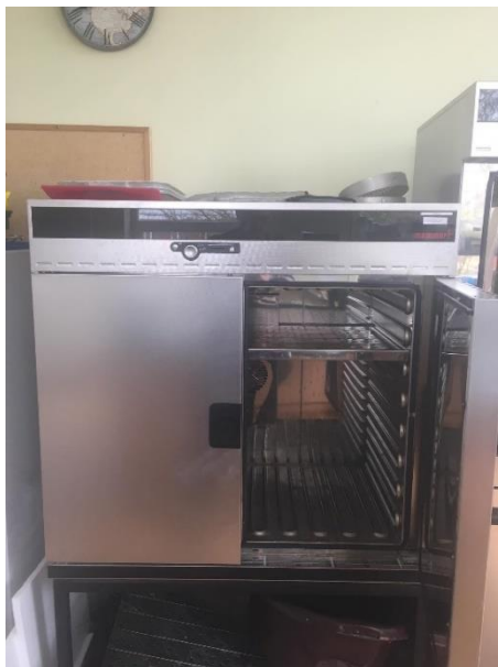
Joonis 1.8. Katsetel kasutatud kuivatuskapp Memmert UFB-500
