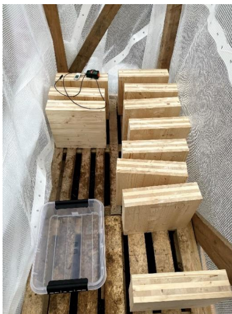
Joonis 1.14. Katsekehade konditsioneerimine välja rajatud varjualuses
