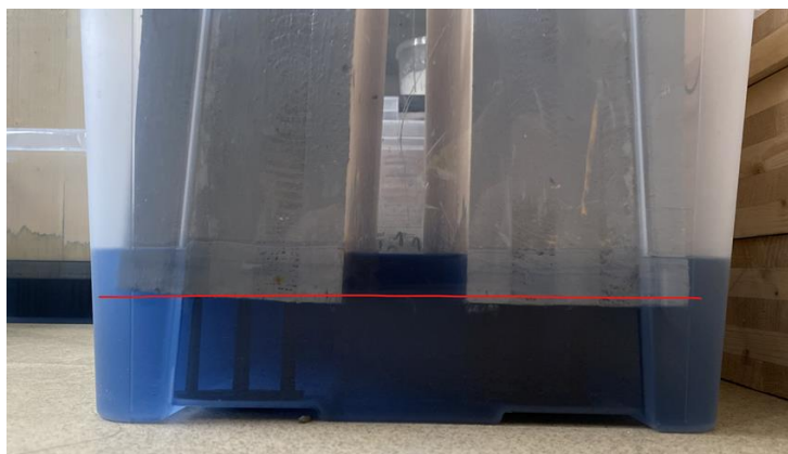
Joonis 1.11. Testkatses ebatäpne veetase – kõrgus ligikaudu 20 mm. Punasega joonega märgitud soovitud veetase- kõrgus ligikaudu 1-2 mm
