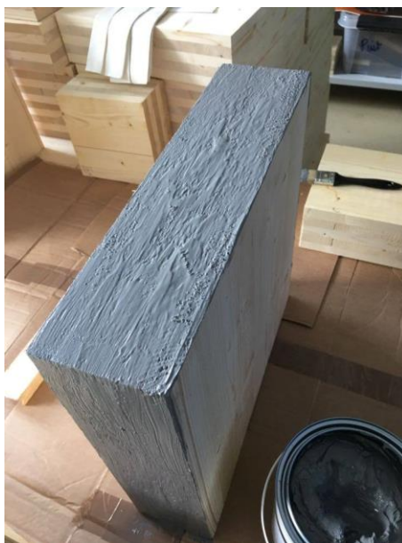
Joonis 1.16. Katsekeha, millele on peale kantud vedelkumm
