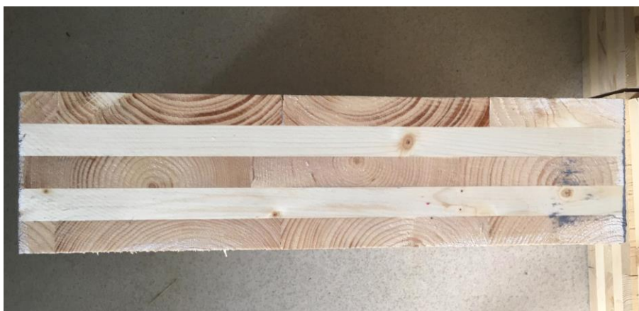
Joonis 1.2. Katsekeha lõikeserv, mis on töödeldud veepõhise akrülaatvärviga
