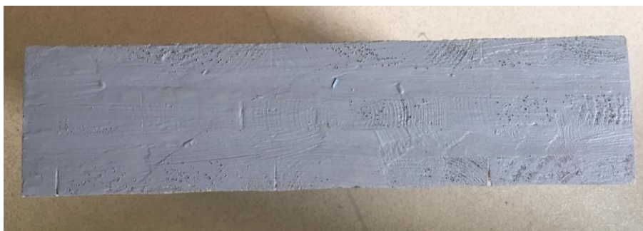
Joonis 1.4. Katsekeha lõikeserv, mis on töödeldud vedelkummiga
