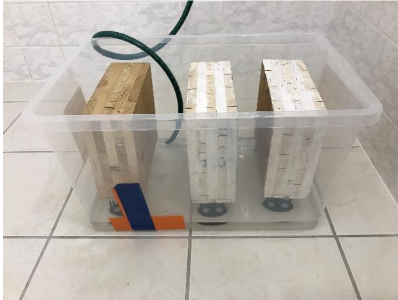
Joonis 1.9. Testkatse läbiviimiseks ehitatud süsteem. Voolikuga tagati pidev vee pealevool
