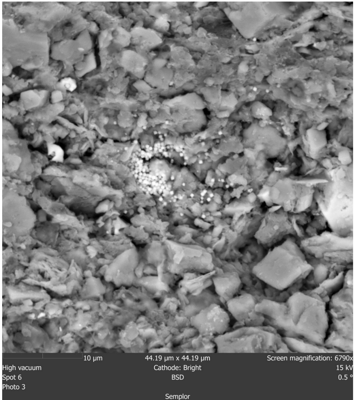
Joonis 8. Hajusa kogumi moodustav mikro-nanokristalliline püriit, framboidi tekke eelstaadium, SEM-BSE kujutis, LL26-04.
