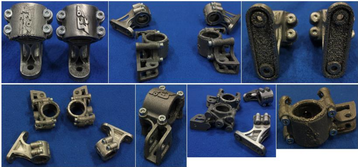
Sele 3.4. Formula Student stabilisaatorvarda kinnitusdetailid
