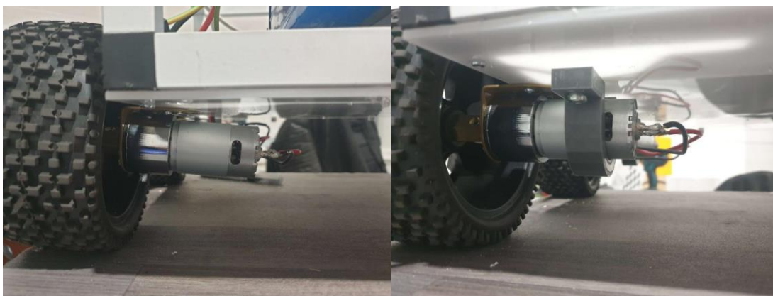
Joonis 3.16 Mootorid enne ja pärast tugede lisamist
