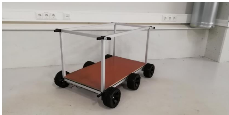
Joonis 3.2 Valmis raam koos vineerplaadiga
