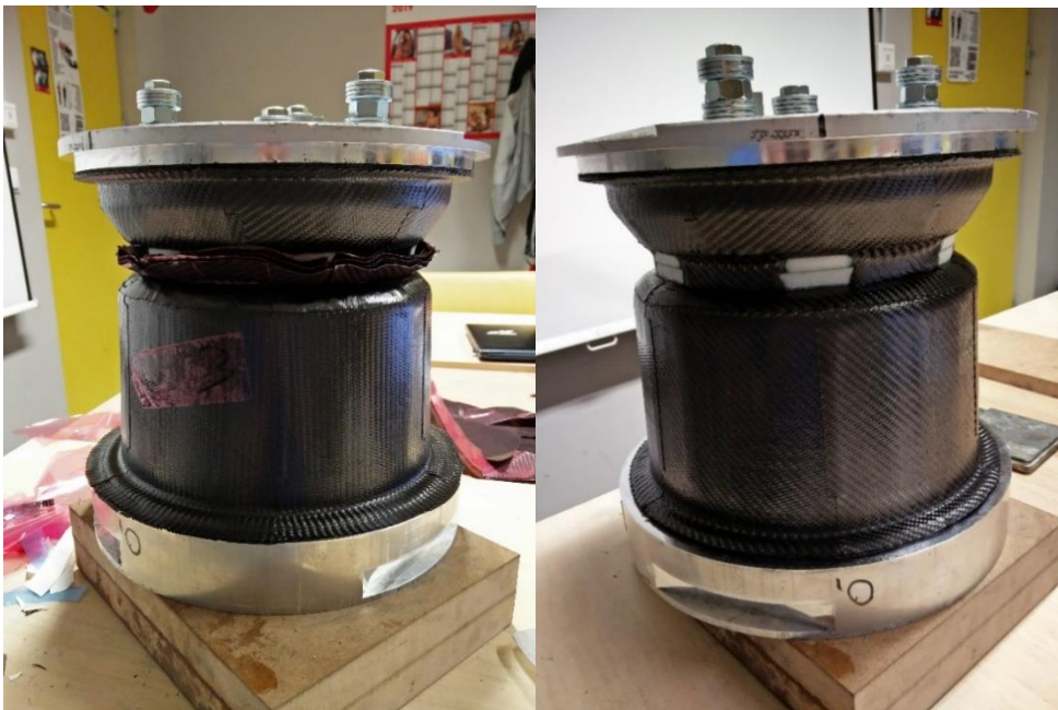
Sele 4.10 Liidetud vormipoolte lamineerimine
