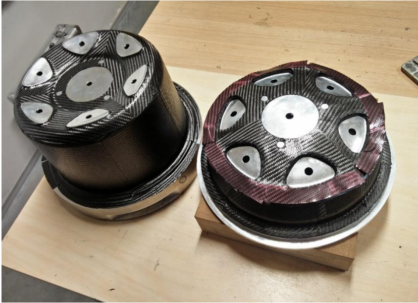
Sele 4.9 Alumine (vasakul) ja ülemine vormipool (paremal)
