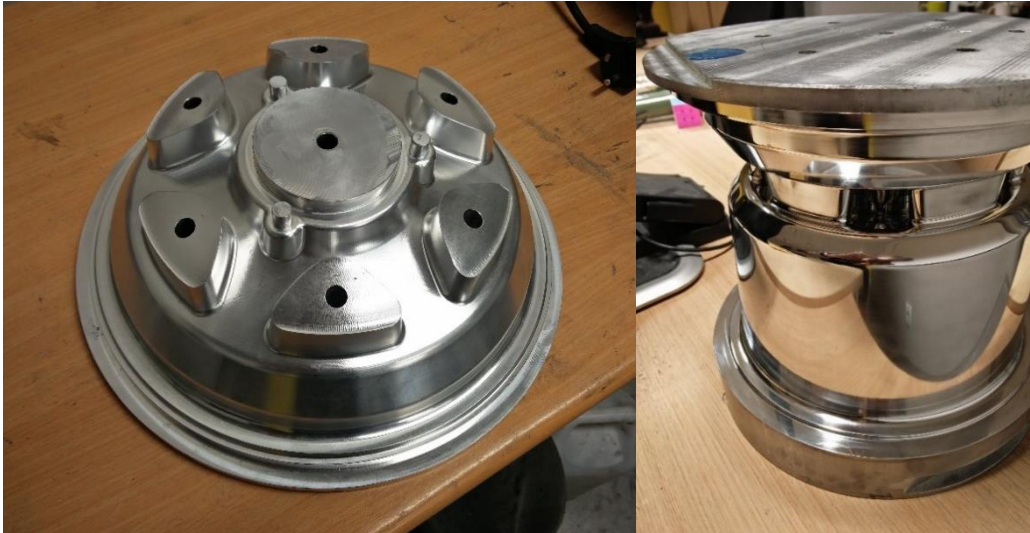
Sele 4.5 Ülemine vormipool peale lõiketöötlust (vasakul), mõlemad vormipooled peale poleerimist (paremal)
