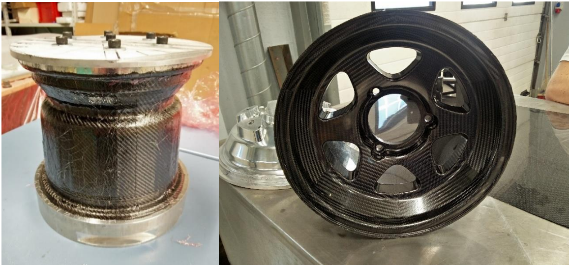
Sele 4.13 Detail peale termotöötlust vasakul ja peale vormist välja võtmist paremal 1
