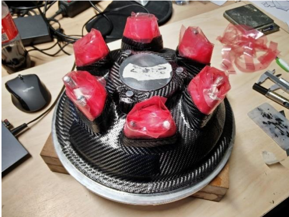
Sele 4.7 Esimese vormipoole kihtide lamineerimine (ülekatte eraldatud roosa eralduskilega)
