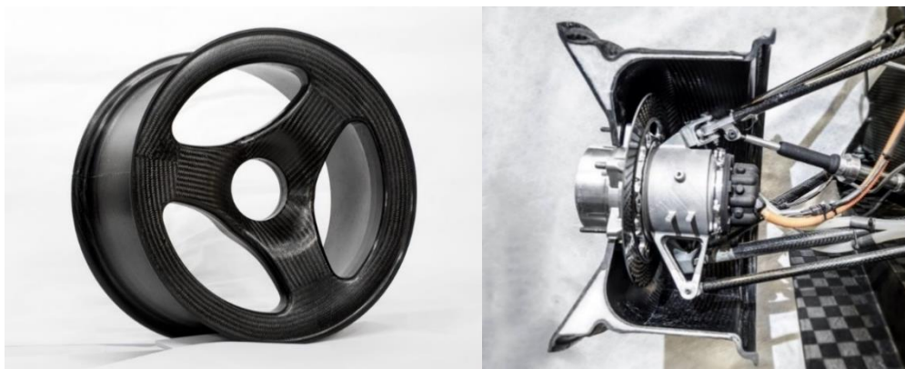
Sele 2.1 KA-Raceing kodarvelg vasakul [3] ja AMZ Racingu täisvelg paremal [4]
