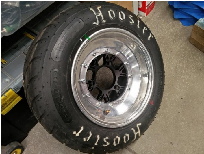
Sele 1.5 2019 aasta hooaja tarbeks valminud alumiiniumist võru ja tsentri kombinatsioon
