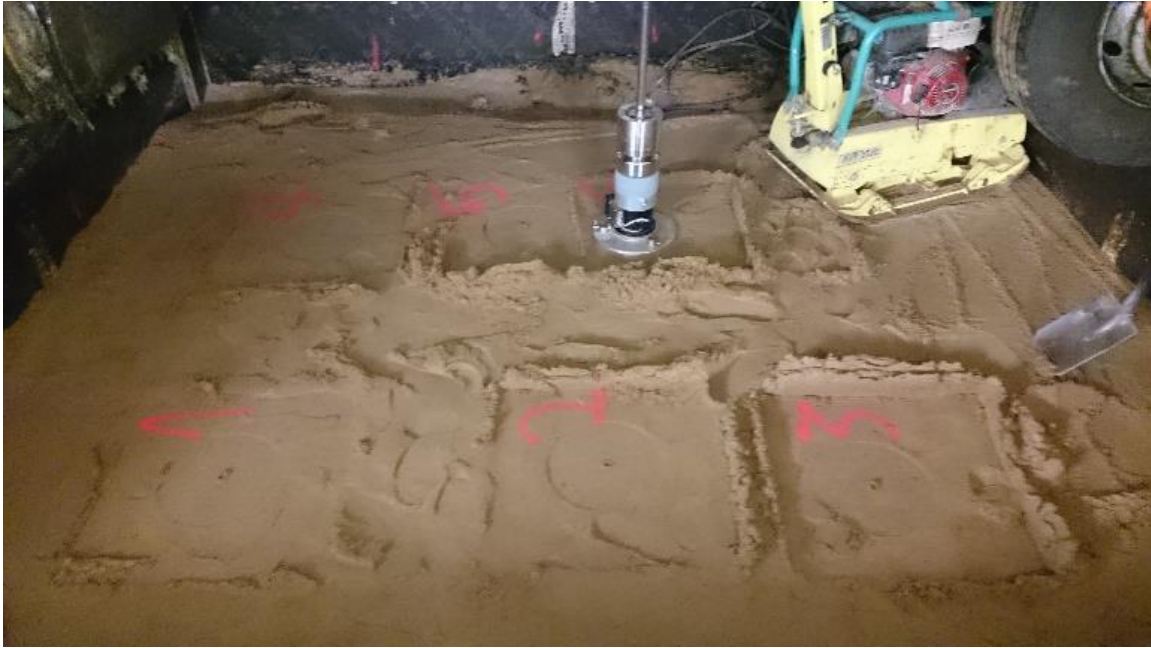
Joonis 7.4 Liiva elastsusmooduli mõõtmine TTK stendil
