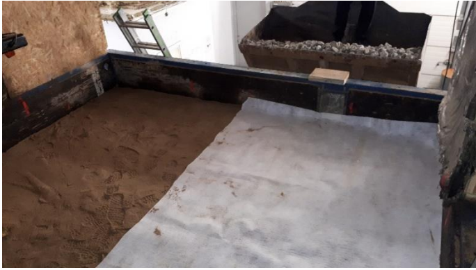
Joonis 7.11 TTK stendil killustikaluse ehitus
