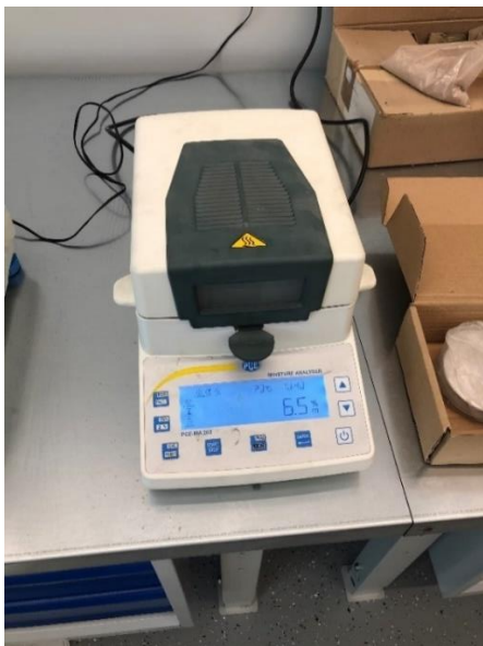
Joonis 7.21 Materjali veesisalduse mõõtmine PCE-MA202 seadmega
