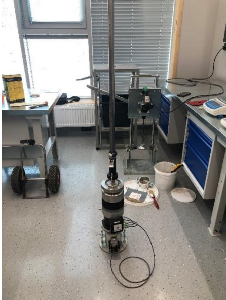
Joonis 7.20 LWD seadmega mõõtmine Proctor-vormil
