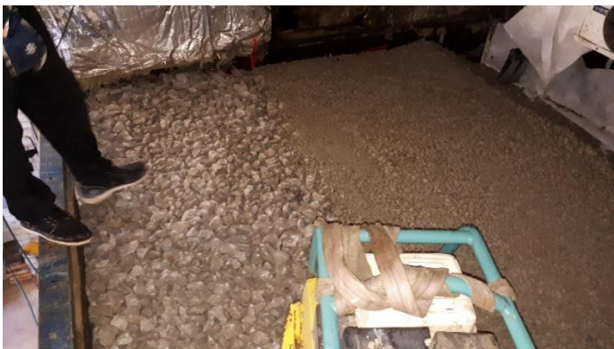
Joonis 7.12 TTK stendil tihendatud killustikalus
