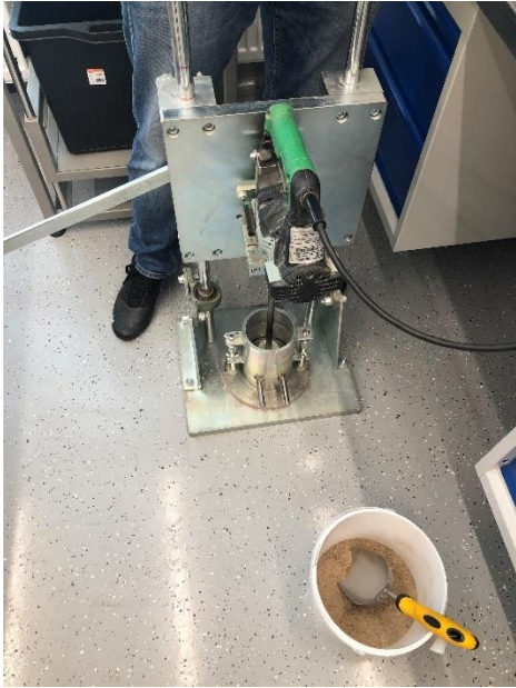
Joonis 7.18 Matest vibrotihendusseadmega Proctor-vormis tihendamine
