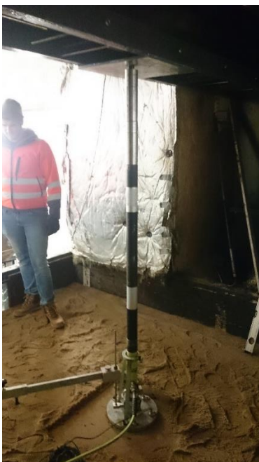
Joonis 7.9 Plaatkoormusseadme ja vasturaskuse vaheline terassilinder
