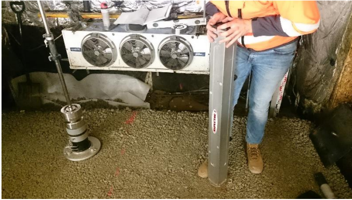
Joonis 7.13 TTK stendil killustikaluse elastusmooduli mõõtmise
