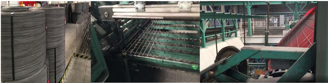
Joonis 1.2.1 Sarrus trumlis, võrgu paigutamine keevitamiseks, võrgu paigutamine raketise magneti abil.
