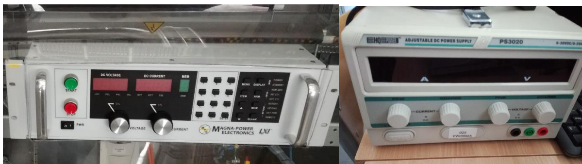
Joonis 4.11 Akuelementide laadimiseks kasutatud toiteallikad (vasakul Magna Power, paremal HQ Power PS 3020)
