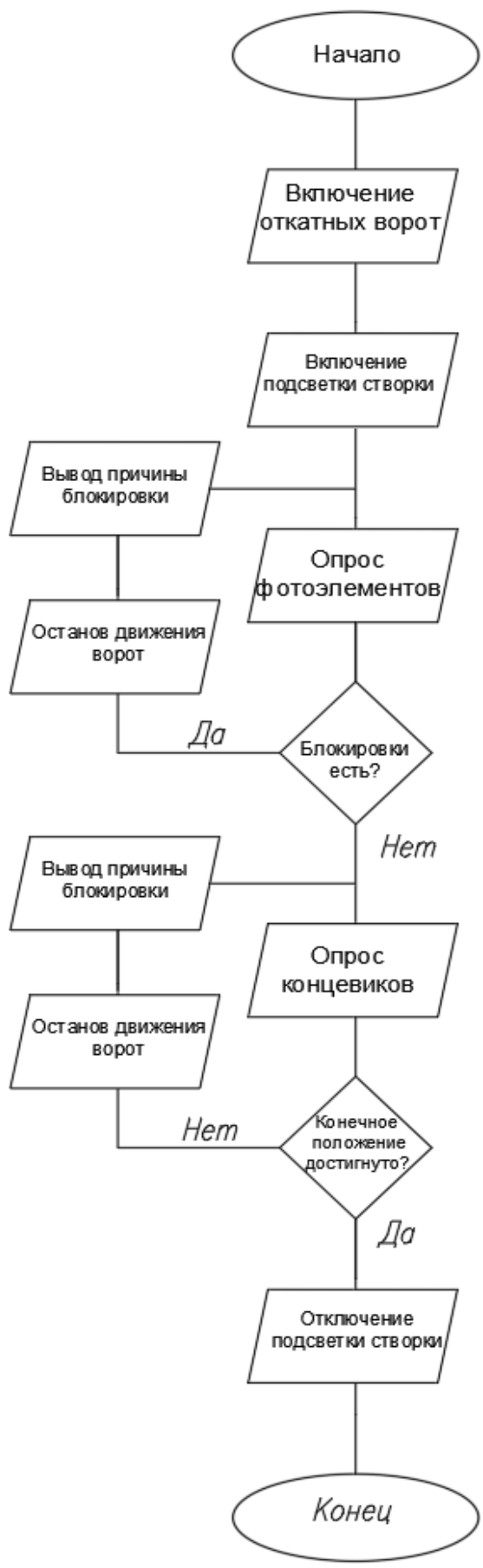
Рисунок 3.1. Алгоритм работы откатных ворот
