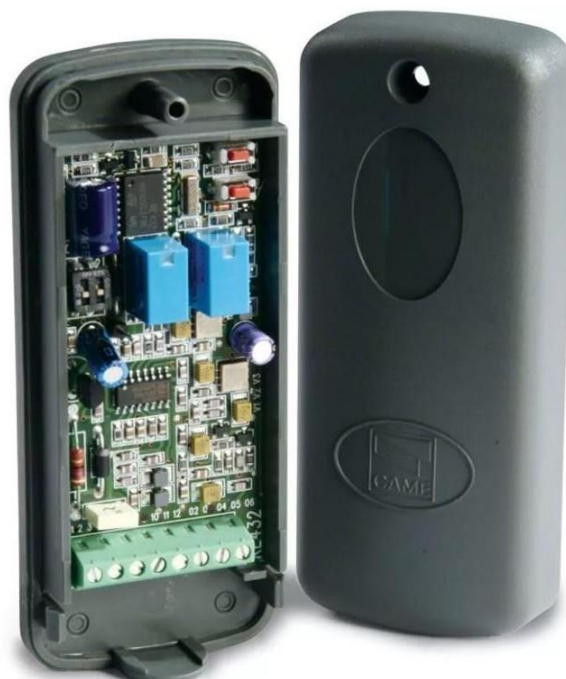
Рисунок 2.6. Внешний вид радиоприемника RE432M [9]
