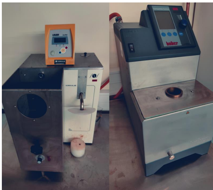
Joonis 1.4 Fraktsioonikoostise määramise aparaat Normalab NDI Basic ja jahutaja Huber ministat 230 [autori foto]
