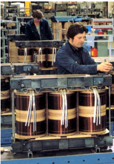
Joonis 1.43. Kolmefaasilise jõutrafo aktiivosa koostamine (vasakul) ja valmis trafo (paremal)
