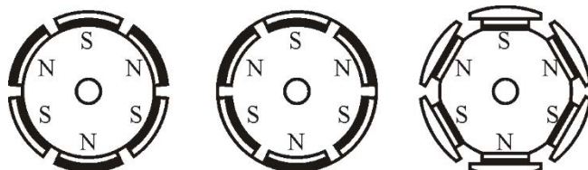
Joonis 6.13. Sünkroonmasina rootor, kus püsिमagnetid on paigutatud välispinnale
