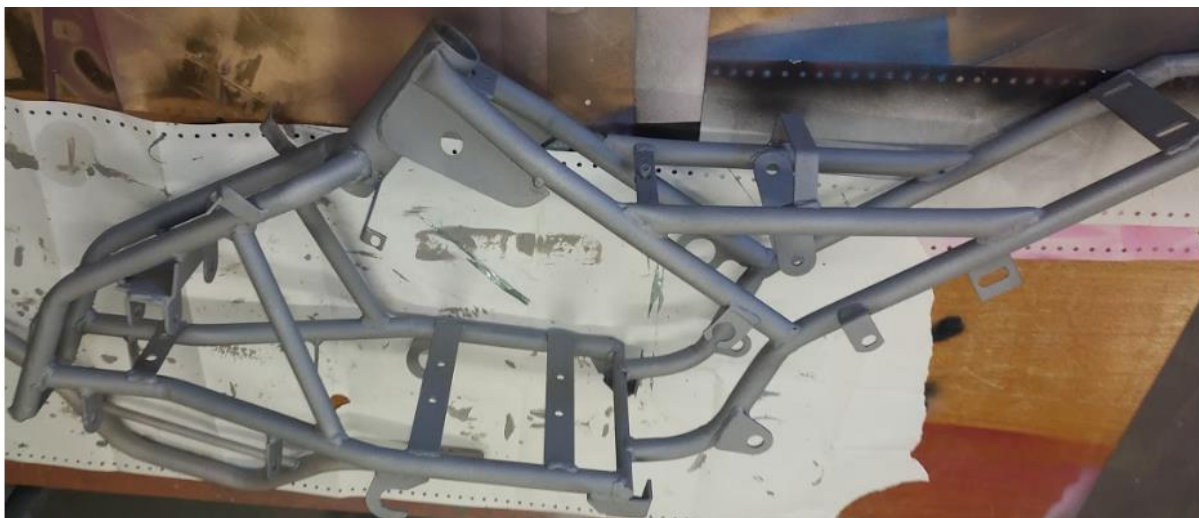
Joonis 2.1 Kartauto põhiraam pärast liivapritsiga töötlemist
