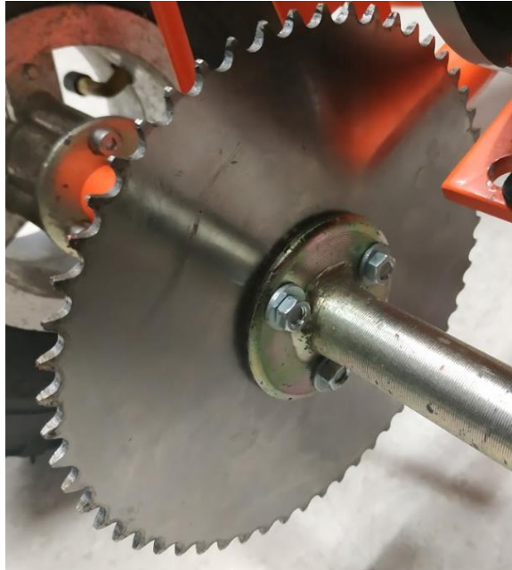
Joonis 2.19 Ketiratas fikseeritud veotelje külge
