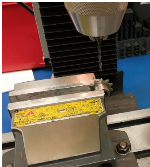
Joonis 2.13 Väiksema ketiratta fikseerimine frees-puurpinkide BF20 Vario
