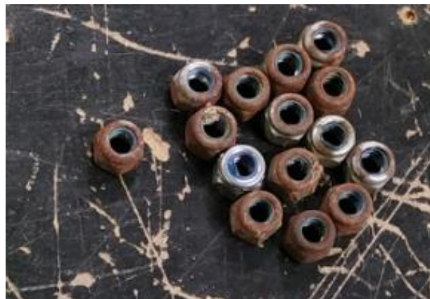
Joonis 1.10 Kartautol kasutusel olnud korrodeerunud mutrid
