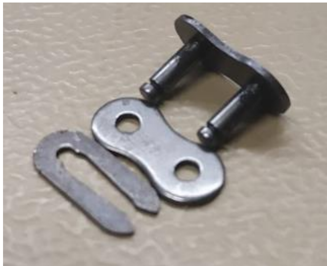
Joonis 2.20 ISO 606 05B-1 keti sirglukk vedrusplindiga
