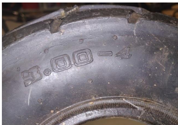
Joonis 2.10 Rehvi seina ja põhja laius ning velje läbimõõt tollides
