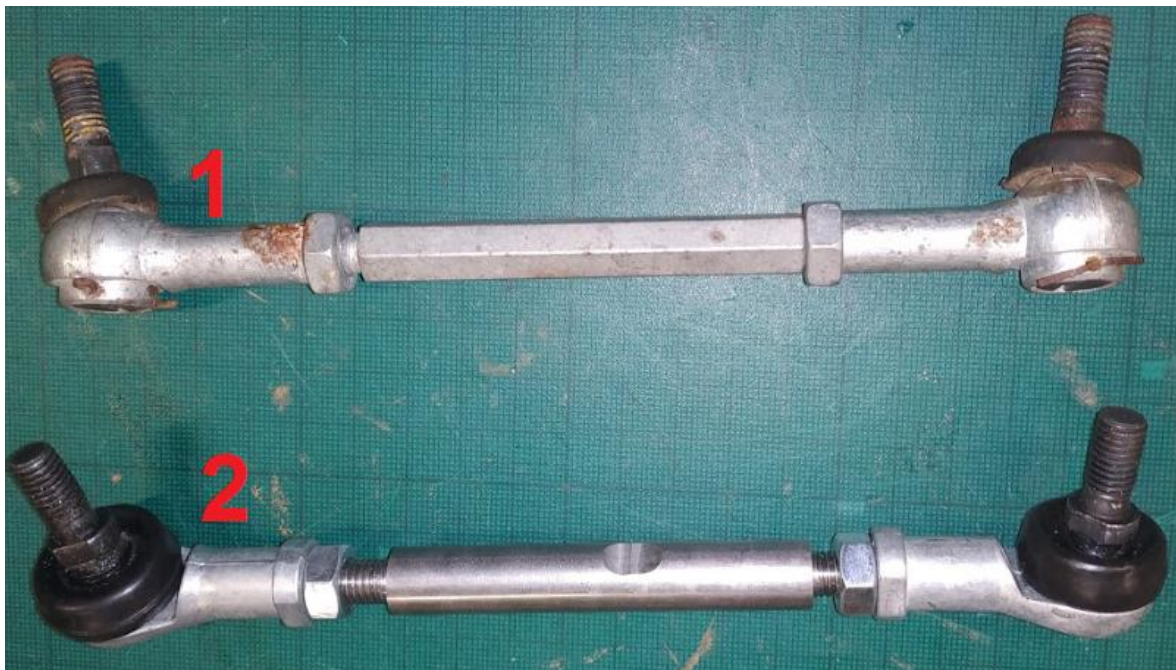
Joonis 2.8 Olulised mõõtmed uue roolivarda valmistamiseks
