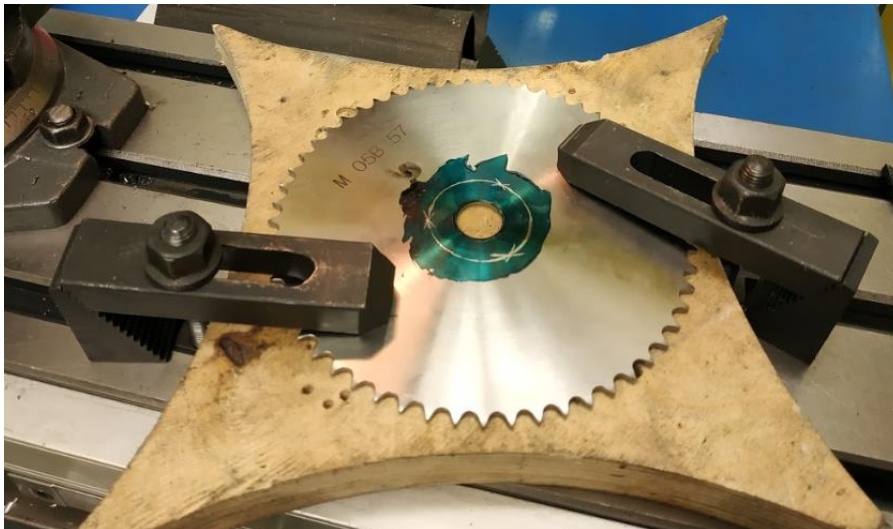
Joonis 2.15 Ketiratta paigutus frees-puurpingis. Ketiratas paigutati puidust alusele ning kinnitati kahe klambri abil töölaua külge. Ristid märgivad puuritavate aukude asukohta.
