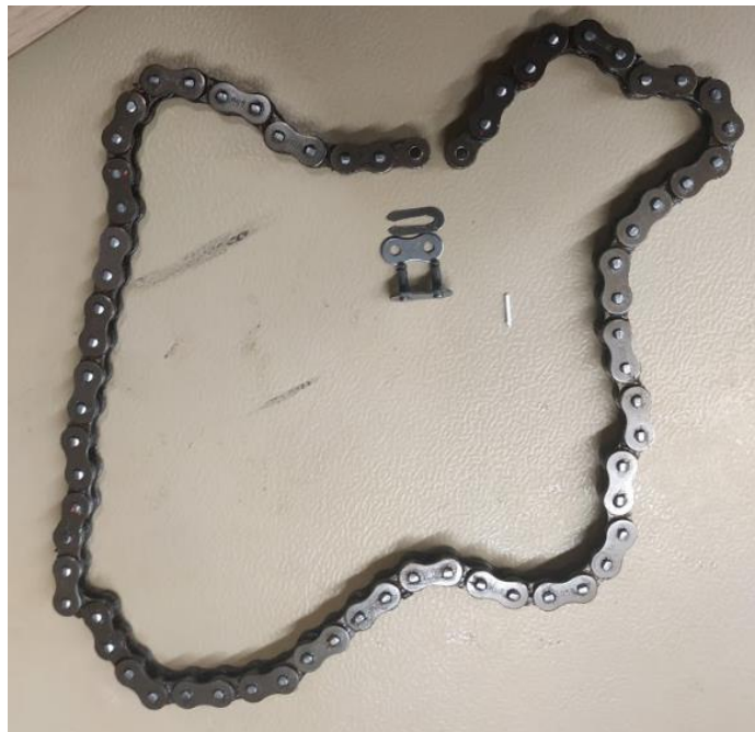
Joonis 2.17 Mõõtu lõigatud veokett 68 lüliga
