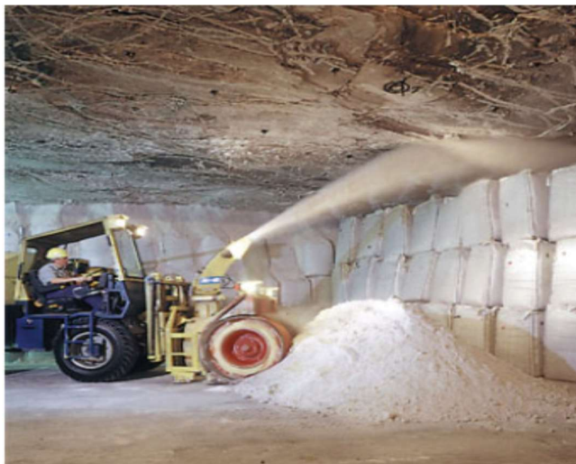
Joonis 1. Mehaaniline täitmine puistates barrikaadi taha täitematerjali. [9]
