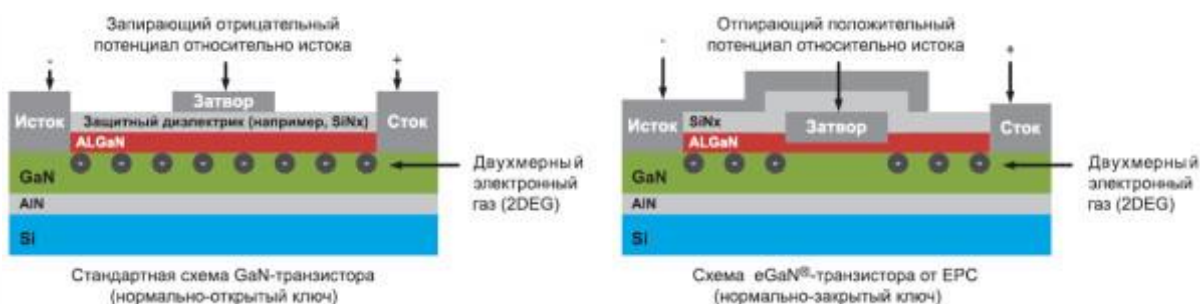
Рисунок 8.7 Традиционная ячейка а) GaN-транзистора и б) eGaN® FET производства EPC [4]
