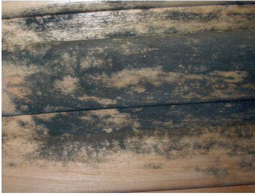
Joonis 3.1 Hallitusseened puidul (Pilt & Konsa, 2012)
