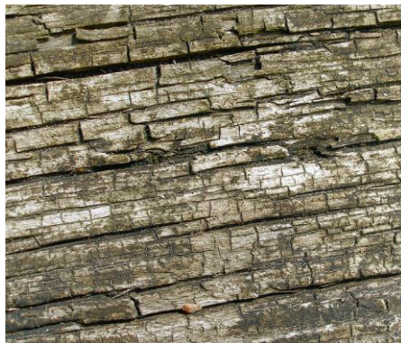
Joonis 3.5 Pehmemädanik puidul (Pilt & Konsa, 2012)
