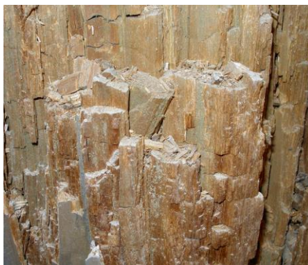
Joonis 3.3 Pruunmädanik puidul (Pilt & Konsa, 2012)
