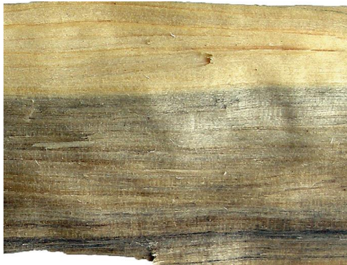
Joonis 3.2 Sinetusseened puidul (Pilt & Konsa, 2012)
