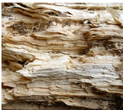
Joonis 3.4 Valgemädanik puidul (Pilt & Konsa, 2012)
