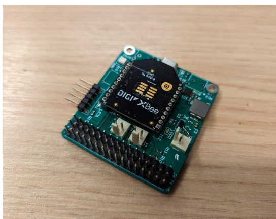
Joonis 4.3 Pisi-Xbee kontrolliplaat, millele on ühendatud Xbee raadiomoodul.
