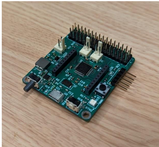
Joonis 3.10 Pisi-Xbee trükkplaat kokku joodetuna.
