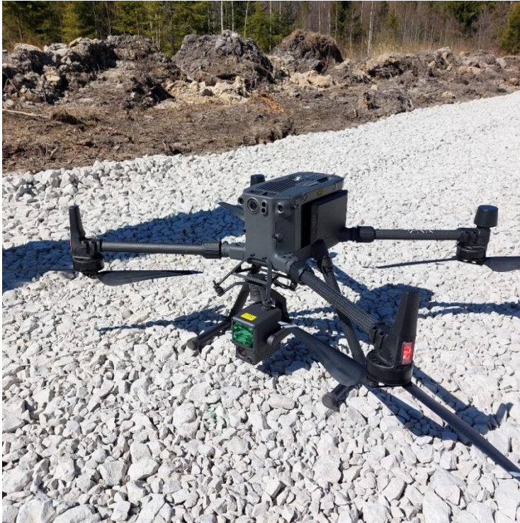
Pilt 5 DJI Matrice 300 RTK droon välitööl, millel on küljes LiDAR seade
