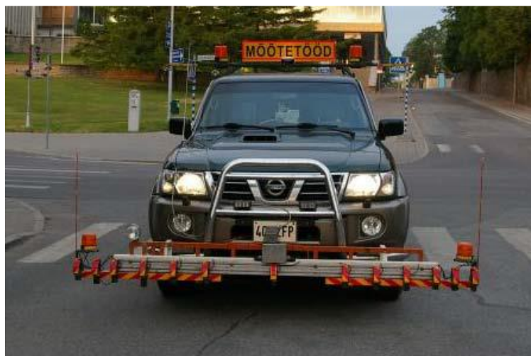
Joonis 1.6 Teekatte roopa sügavuse mõõtmise seade Roobas Roadmaster. Allikas: [9]
