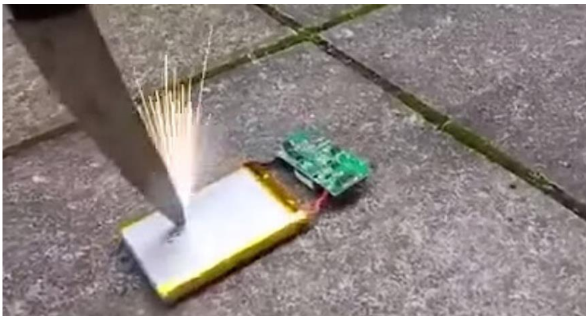
Joonis 24. Sisselõige Li-ion elementi [18]
