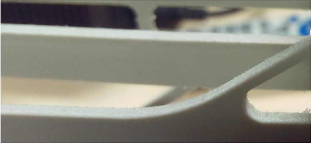
Joonis 7. Detailide lõikejoone krobeline pind
