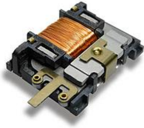
Joonis 4-1: Lüliti, mis toodab saatmiseks vajaliku energia vajutamisega [3]
