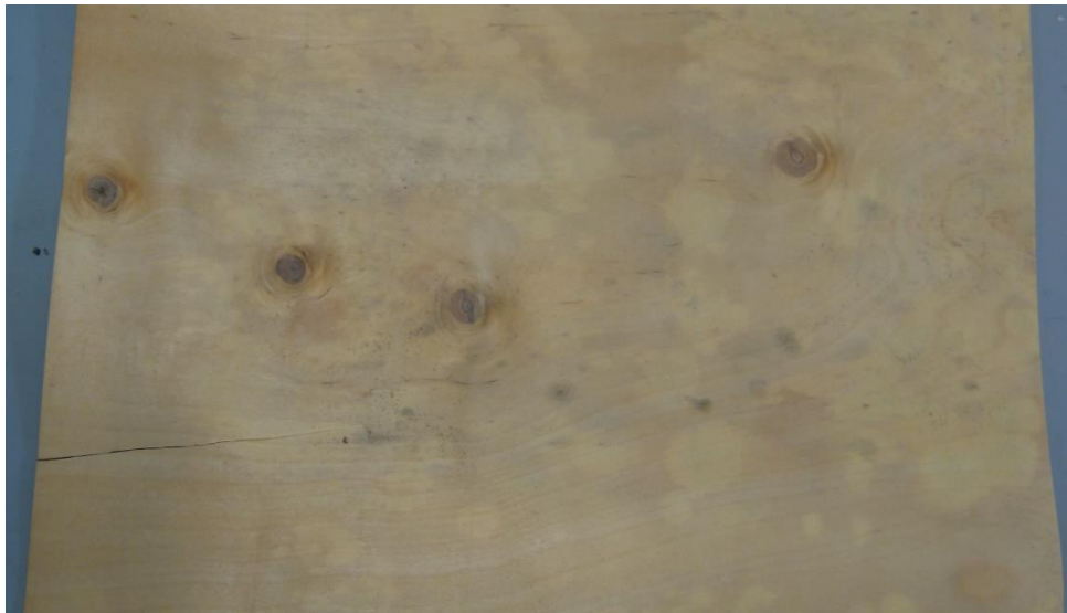
Joonis 4.2 Hallitanud spoonileht TTÜ puidutehnoloogia laboris
