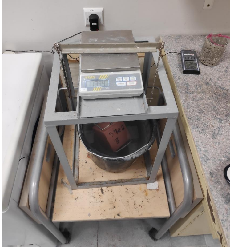
Joonis 2.5 Katsekehade tiheduste määramine [Autori erakogu]
