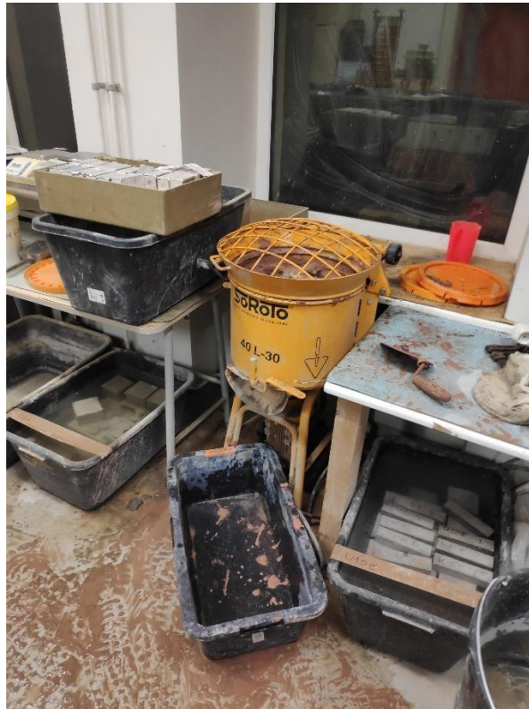
Joonis 2.3 Mördi valmistamine betoonisegistiga ja vann kus segati täiendavalt tuhasegusid [Autori erakogu]
