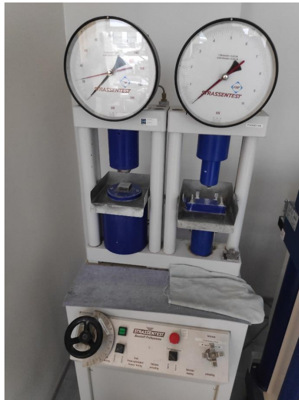
Joonis 2.7 Painde- ja survetugevuse hüdrauliline press "Strassentest " [Autori erakogu]
