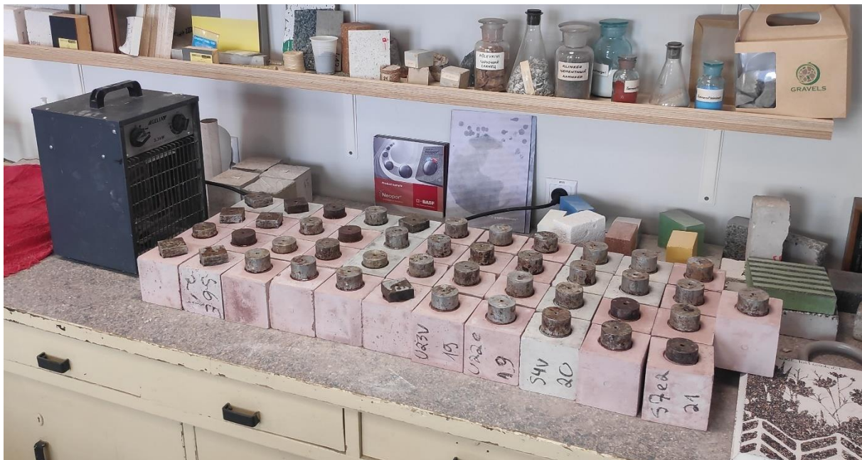
Joonis 2.8 Äratõmbe katsekehade kuivatamine [Autori erakogu]
