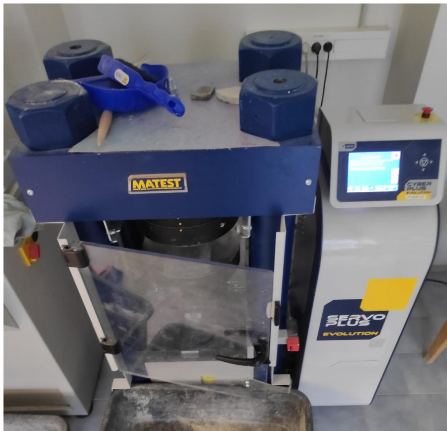
Joonis 2.6 Hüdrauliline press survetugevuse määramiseks [Autori erakogu]
