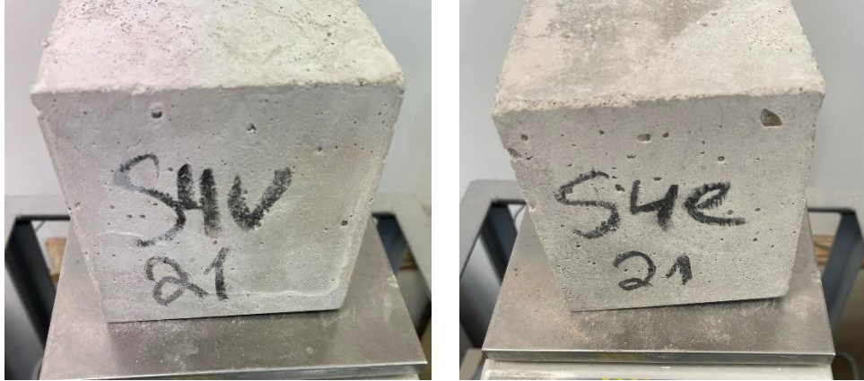
Joonis 2.2 Näited katsekehade tähistamisest [Autori erakogu]
