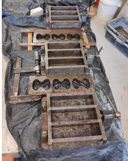
Joonis 2.4 Tõmbe- ja paindekatsekehade vormide ettevalmistus [Autori erakogu]
