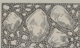
Joon. 11. Tsement täidab betoonis liivaaterade vahed. Mida mitmekesisem on liiv, seda vähem läheb tsementi.
