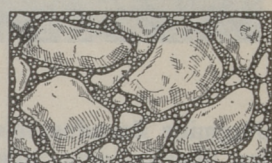
Joon. 11. Tsement täidab betoonis liivaaterade vahed. Mida mitmekesisem on liiv, seda vähem läheb tsementi.
