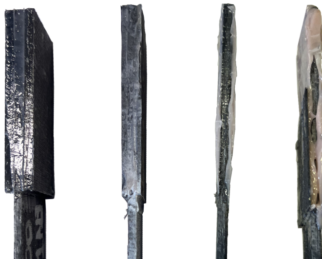
Joonis 11. Vasakult: Esialgne katsekeha (paksendused katsekehaga samast tahvlist); pooleks lõigatud paksendusega katsekeha; ainult epoliimiga katsekeha; õhemast süsinikkiust paksendused
