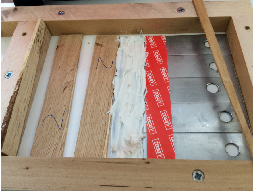
Joonis 12. Liimi pealekandmine liiaga, üleliigne pressitakse välja.
