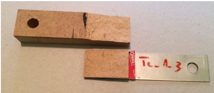
Joonis 19. Purunemine toimus puidus.
