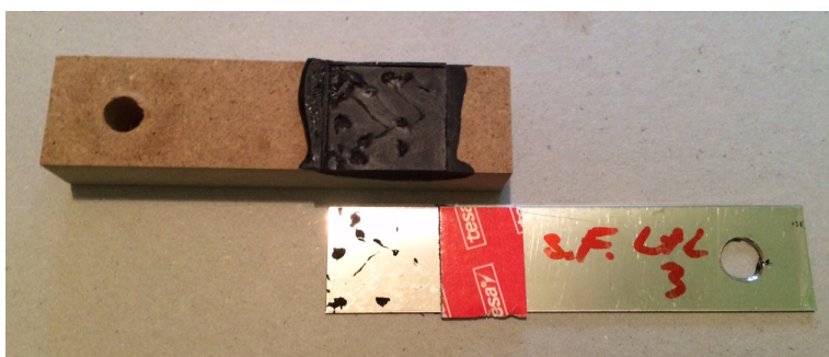
Joonis 17. Liim on lahti tulnud metalli küljest.
