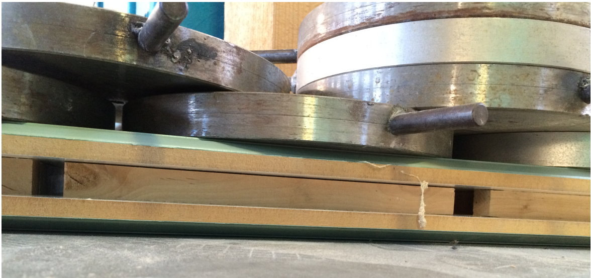
Joonis 13. Rakised küljelt peale asetatud jäiga tasapinnalise plaadi ning raskustega.
