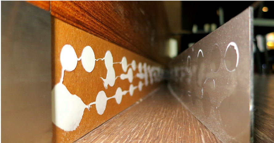
Joonis 8. Liim on kantud pindadele enamasti täppidena.
