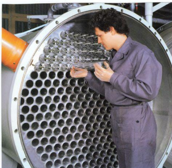
Joonis 10.7. Klaastorst dielektrikute paigaldamine osonaatorisse
