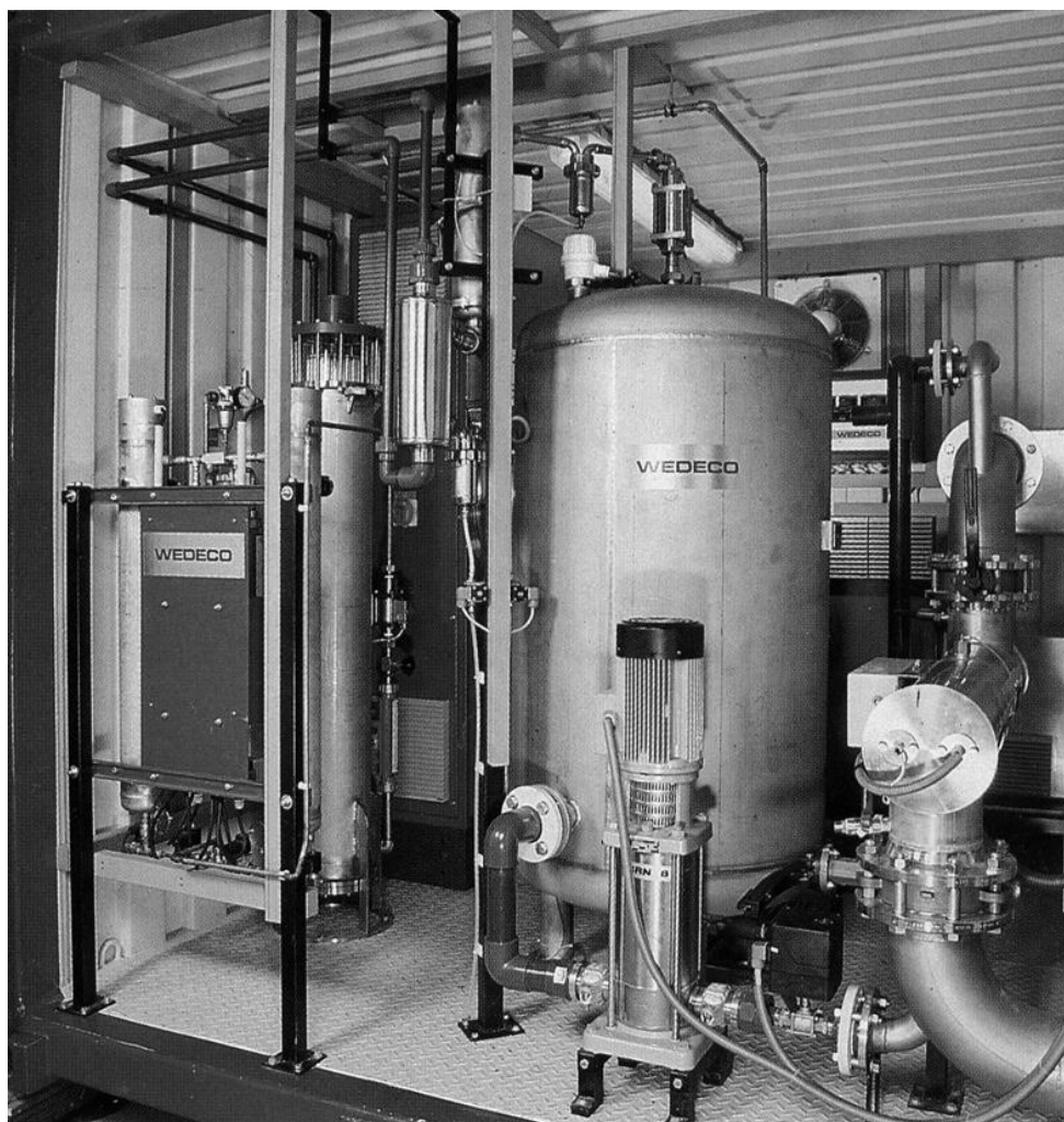
Joonis 10.11. O 3 + UV-seade konteinerpuhastis tootlikkusega 120 m 3 /h
