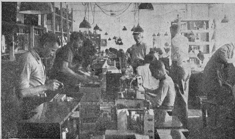
Vaade montaažruumi. Esiplaanil lindi lõpp, kus toimub kastipaneek.
