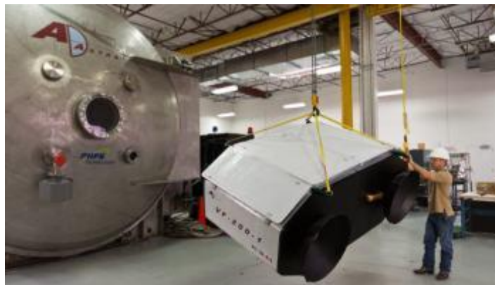
Joonis 8. VF-200 prototüüp kahe 100kW plasmamootoriga [35]
