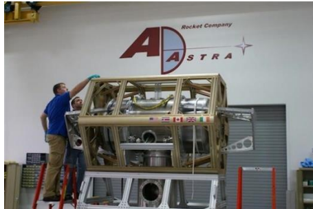
Joonis 7. VASIMR VX-200 mootor ja selle testimine [32] [31]
