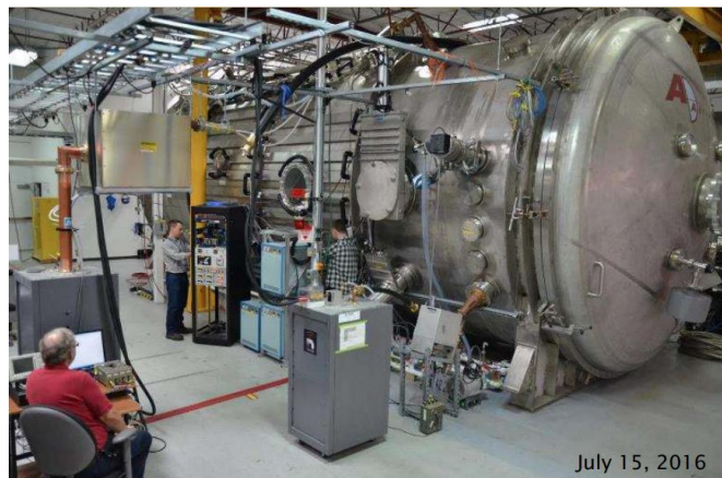
Joonis 22. VASIMR mootor VX-200SS, mis on vaakumkambriga ümbritsetud [66]
