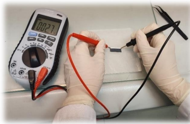
Joonis 2.10 Kollektorriba takistuse mõõtmine
