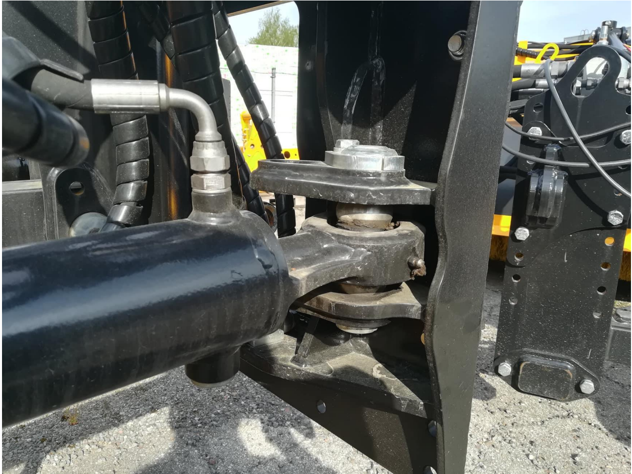
Joonis 2.8. Hüdrosilindri kinnitus raami poolt.
