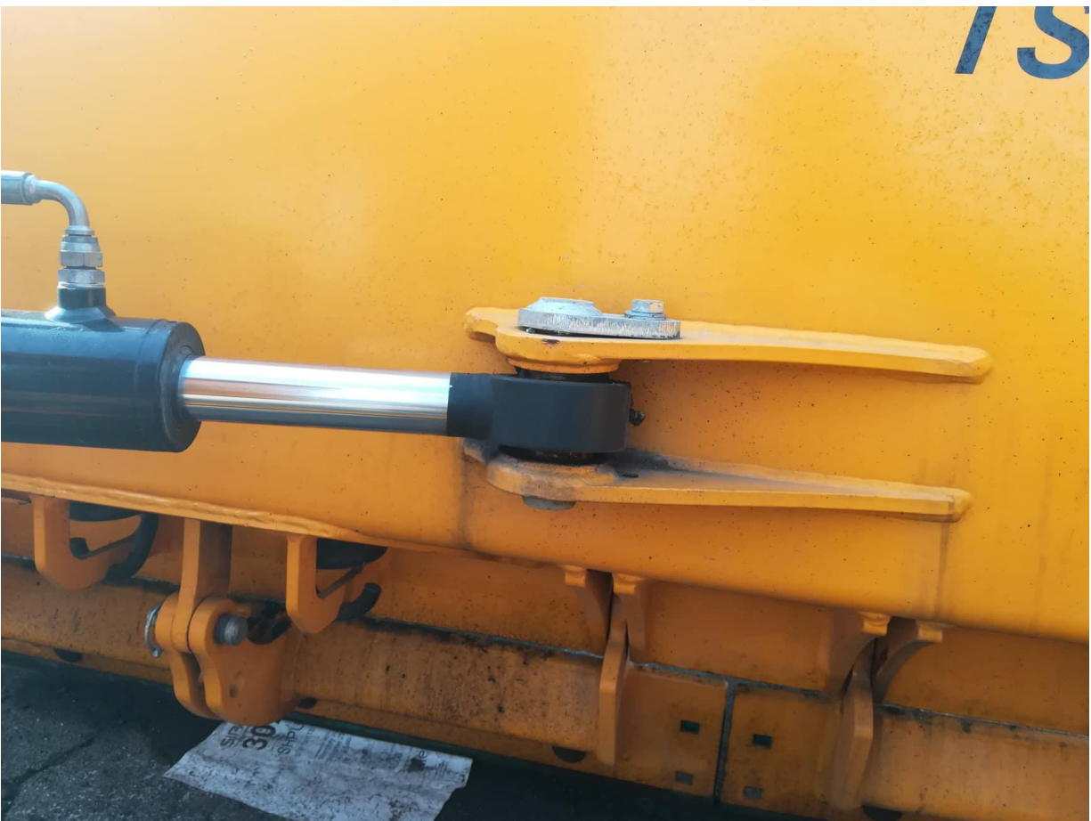
Joonis 2.7. Hüdrosilindri kinnitus hõlma poolt
