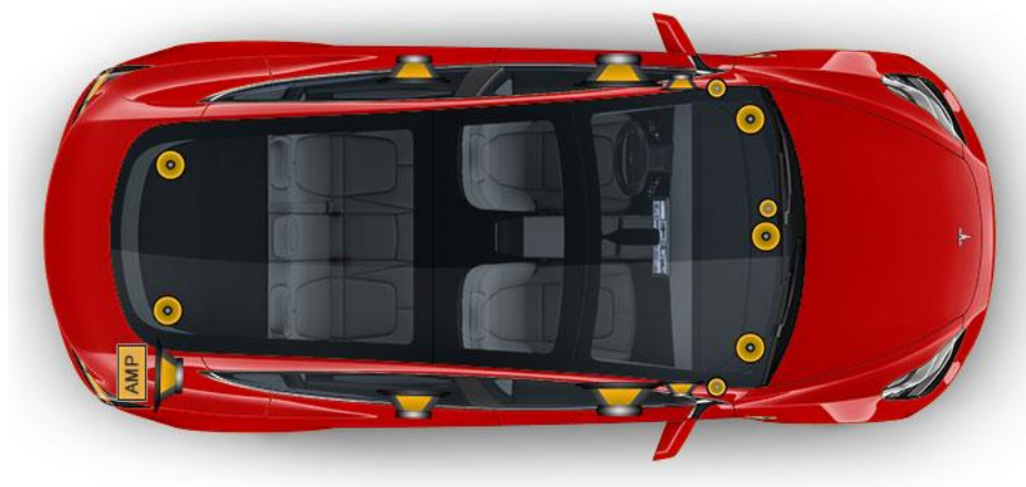
Joonis 3.1. Tesla Model 3 Long Range helisüsteemi komponentide paigaldus [22]
