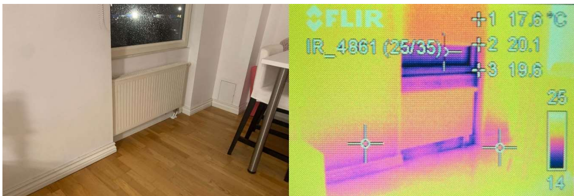
Joonis 2.1.7.1-3: Tuulutatava tarindi termokaamera analüüs
