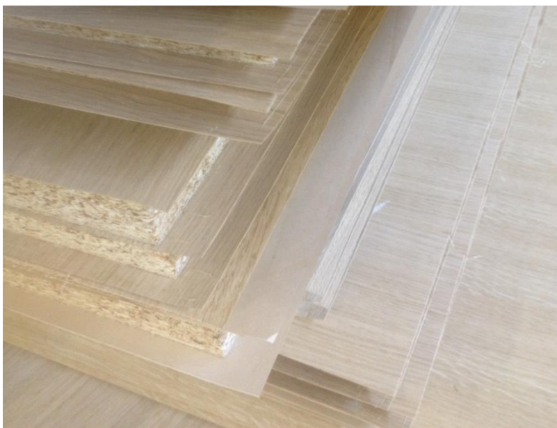
Joonis 8. Puitplaatide pealistanisel jäetav varu
