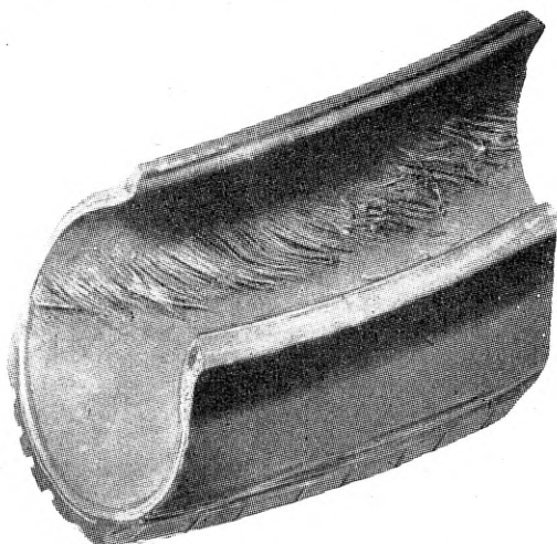
Joon. 26. Liiga suure läbipaindumise tagajärjel rebenenud kude.
