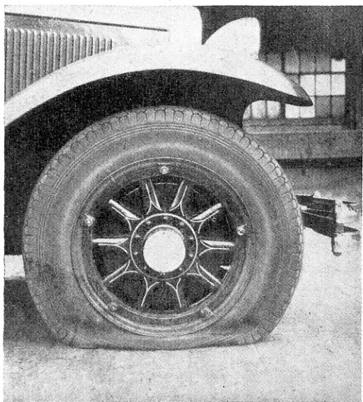
Joon. 25. Tühja kummiga ei tohi üldse sõita.
