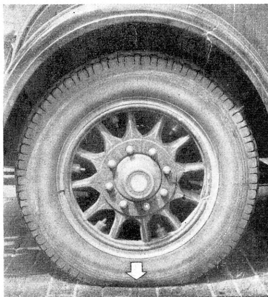
Joon. 24. Puudulik õhurõhk põhjustab rehvi vigastusi.
