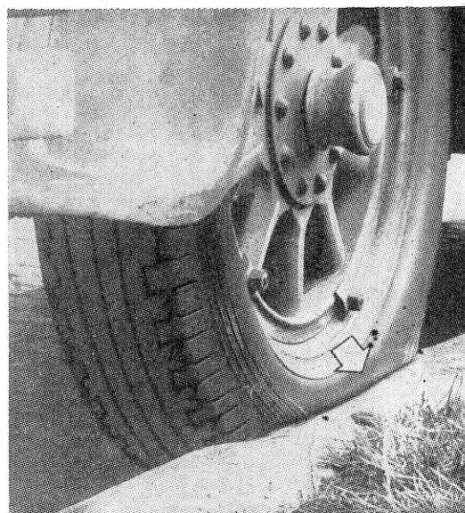
Joon. 27, 28, 29. Näiteid, kuidas puuduliku õhurõhuga sõitmisel rehvid võivad vigastuda.
