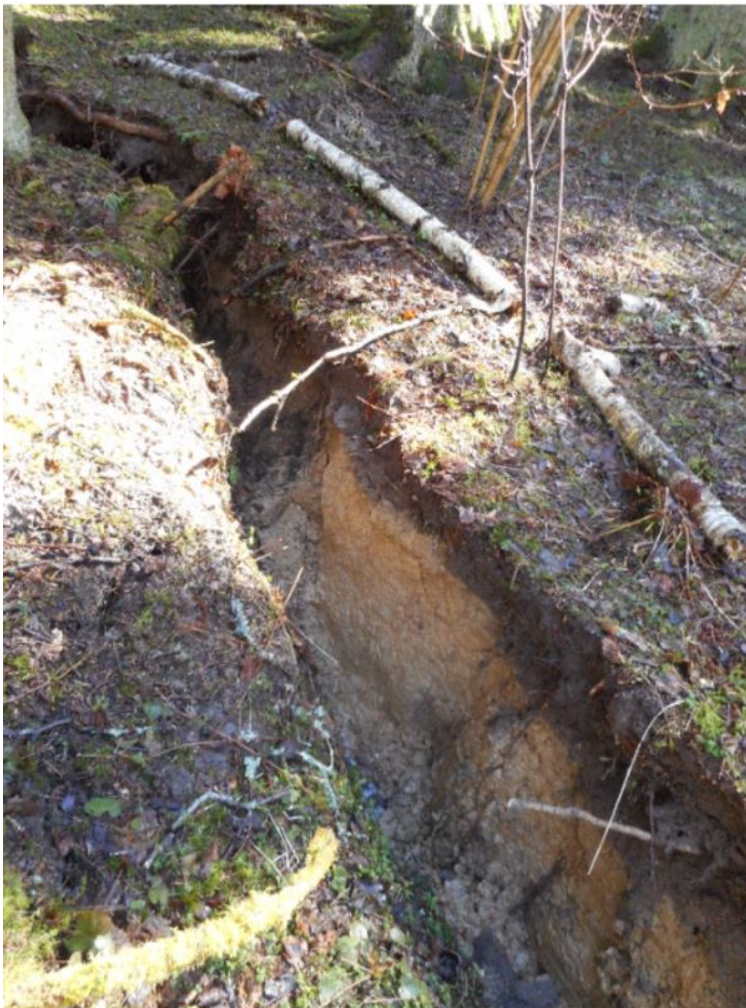
Joonis 12 Rebenemispind avaldub maapinnal lõhena.
