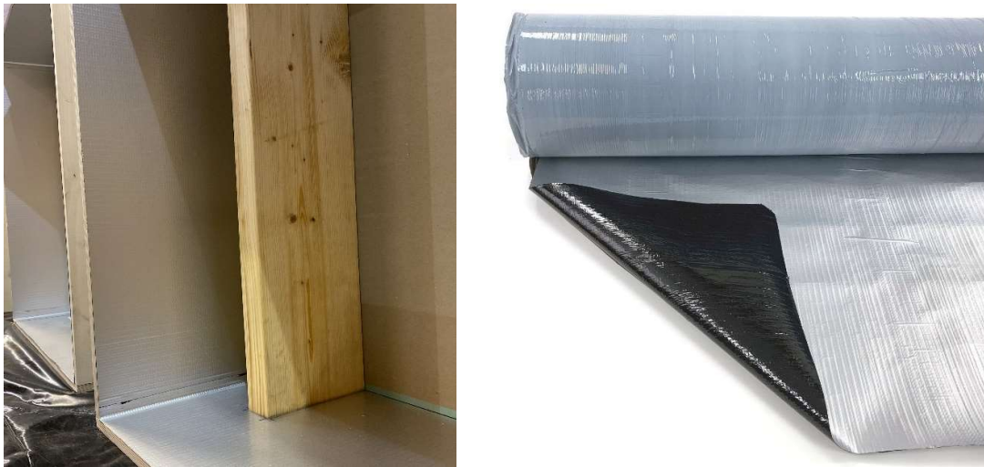
Joonis 2.2 Vasakul bituumpõhjaga alumiiniumlaminaat, paremal alumiiniumlaminaadiga kaetud vineerist testseina raam
