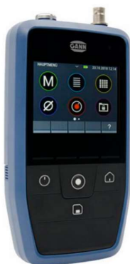
Joonis 2.13 Vasakul Gann Hydromette CH17, paremal Logica Holzmeister LG9 NG puidu niiskussisalduse mõõtmise seade, vasakul pildil on kujutatud ka elektroodide paigaldamiseks kasutatud ramm-vasar
