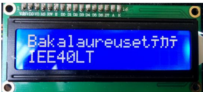
Joonis 4. LCD ekraan programmikoodi katsetamisel
